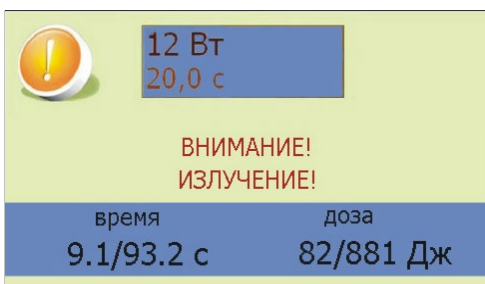
в) с включенными счетчиками времени подачи и дозы лазерного излучения
