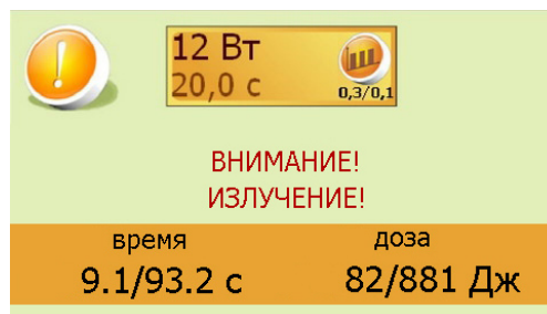
г) с включенными счетчиками времени подачи и дозы лазерного излучения
